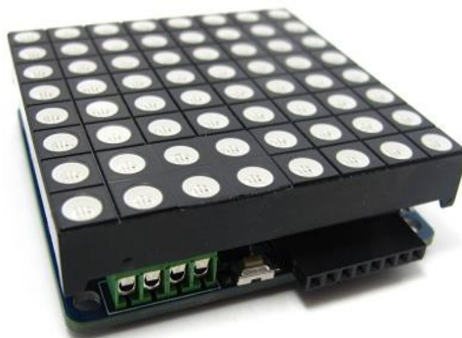
איור 2 – מבט על כרטיס הקולורדואינו עם מטריצת לדים של 8*8 המחוברת אליו.
